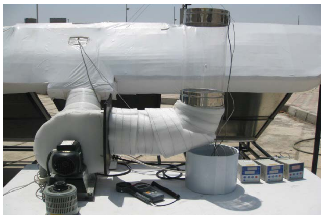
شکل ۲: الف - نمای روبروی خشک کن شامل جمع کننده های خورشیدی هوا ب - نمای پشت خشک کن شامل محفظه بستر سیال، دمنده حلزونی، کانال هوا و تجهیزات اندازه گیری
