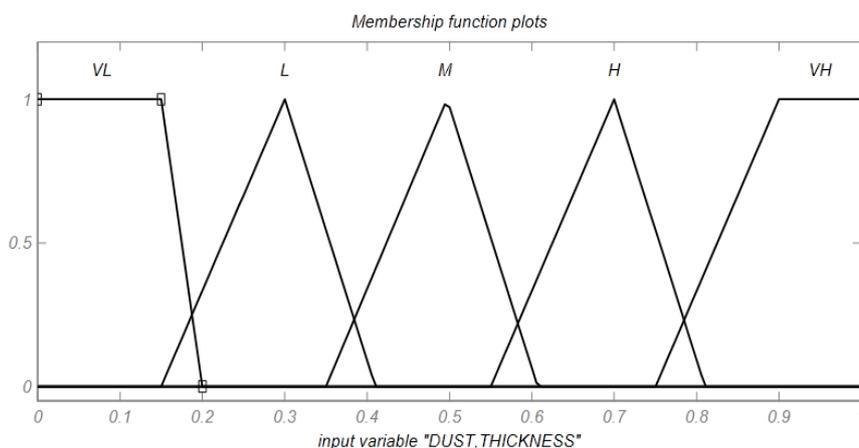
شکل ۸: توابع عضویت ورودی ضخامت گرد و غبار
