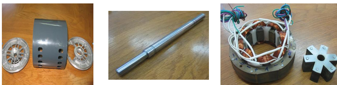
شکل ۱۰: نمایی از روتور، استاتور سیم‌بندی‌شده، شفت، پوسته و درپوش‌های موتور
