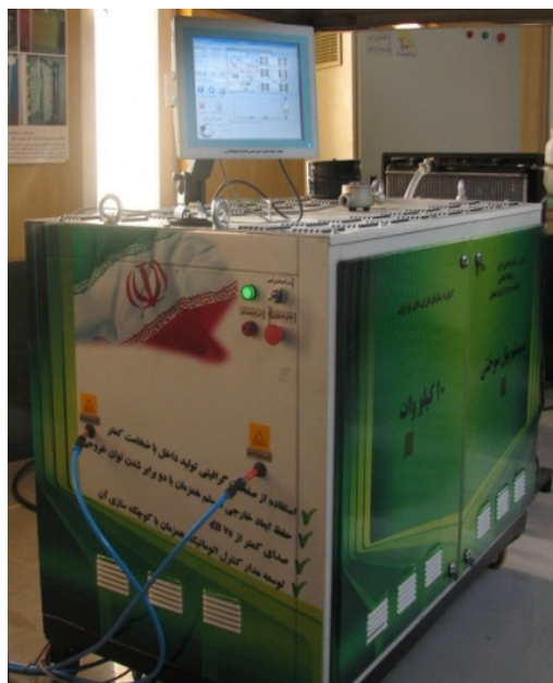
شکل (۳) پکیج تجهیزات جانبی سیستم پیل سوختی ده کیلووات
