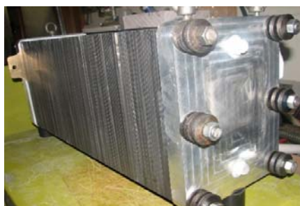
شکل ۲) نمایی از کامپوزیت‌های ساخته شده در استک ۱۰ کیلووات
