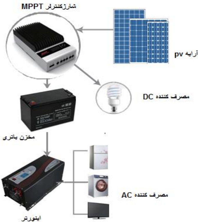
شکل ۲. طرحواره سامانه مستقل فتوولتاییک تولید برق.
