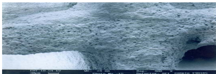
شکل(۵): تصویر تقاطع دو دیواره‌ی مونولیت لانه زنبوری با بزرگنمایی ۴۰۰ برابر
