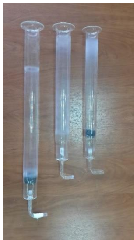
شکل ۳. راکتور احتراقی با طول و قطرهای مختلف
