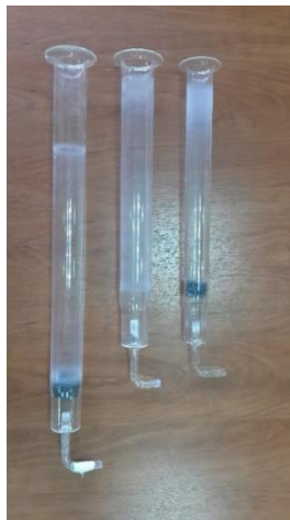
شکل ۳. راکتور احتراقی با طول و قطرهای مختلف
