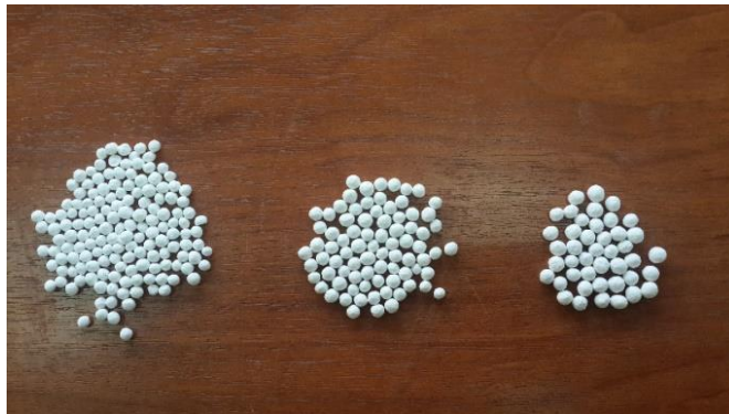
شکل ۴. گرانول‌های اکسید آلومینیوم با قطرهای ۱، ۳ و ۵ میلی‌متر
