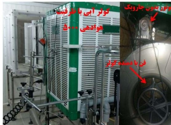
ب) موتور بدون جاروبک نصب شده روی کولر آبی
