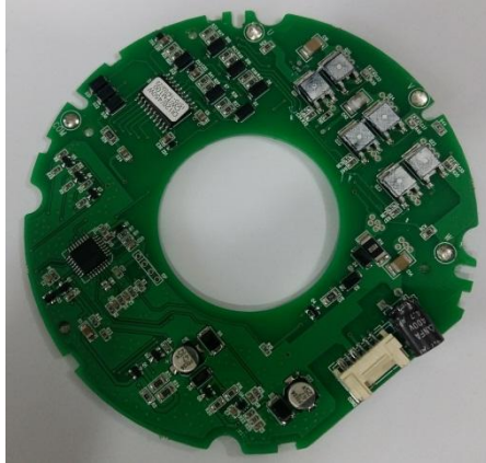
الف) برد اینورتر و کنترل درایو
