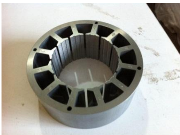
الف) هسته استاتور موتور بدون جاروبک طراحی شده
