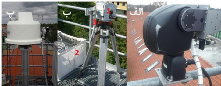
شکل ۴. سیستم‌های ردیاب. الف) دستگاه PTU، ب) سیستم مکانیایی ENEO، پ) سامانه اسکای-اسکنر ۱
