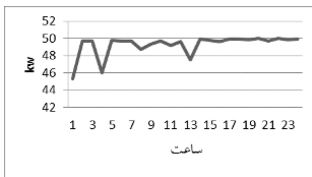
شکل (۲۱): توان تولیدی توسط میکروتوربین میکروگرید ۲ در ۲۴ ساعت
