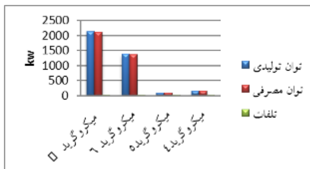
شکل (۱۶): میزان توان تولیدی، توان مصرفی و تلفات در ساعت ۱۵ سناریوی ۲
