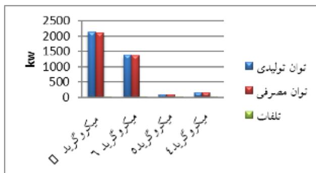
شکل (۱۶): میزان توان تولیدی، توان مصرفی و تلفات در ساعت ۱۵ سtarیوی ۲
