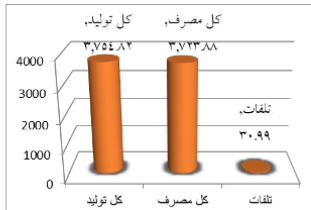
شکل (۱۳): توان تولیدی، توان مصرفی و تلفات در ساعت ۱۵ سناریوی ۲
