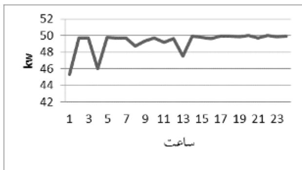
شکل (۲۱): توان تولیدی توسط میکروتوربین میکروگرد ۲ در ۲۴ ساعت
