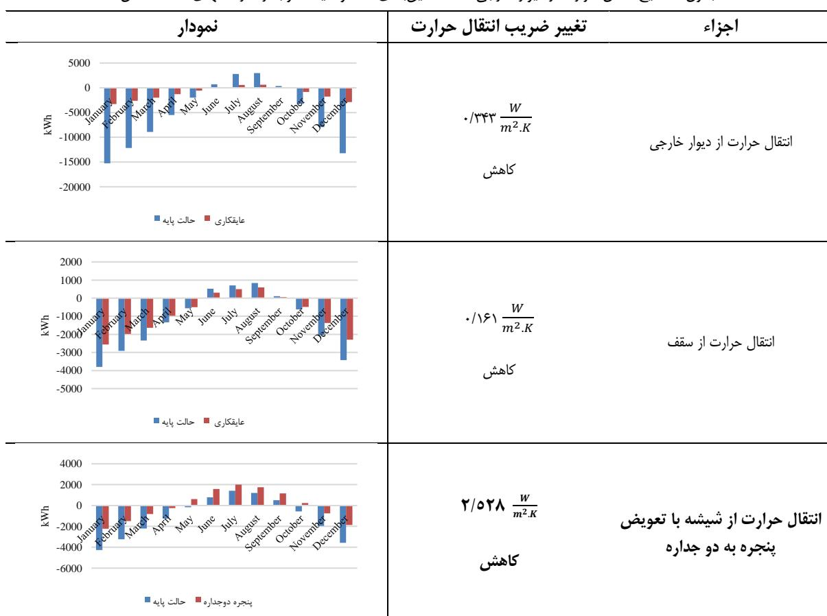
شبیه سازی ساختمان با گلخانه خورشیدی و مصالح عایق بندی شده با دریچه تهویه و بدون دریچه تهویه: در این حالت از ۱۰ سانتی متر عایق پشم سنگ برای سقف و دیوار و ۵ سانتی متر برای دیوار خارجی بالکن، و از دریچه به ابعاد ۳۰ در ۵۰ سانتی متر برای تهویه استفاده گردید. نتایج انتقال حرارت از دیوار خارجی، سقف و شیشه دوجداره در ماههای مختلف سال مطابق جدول ۹ می باشد. مطابق نتایج، با عایقکاری و تعویض پنجره اتلاف حرارت از دیوار ۷۸ درصد، از سقف ۳۱ درصد و از شیشه ۳۸ درصد کاهش یافته است.
