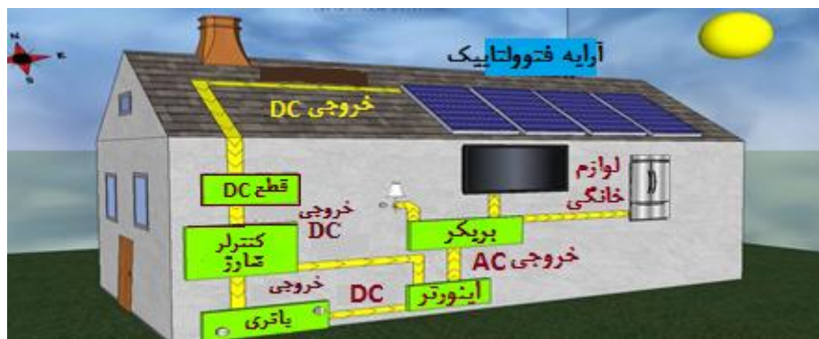
شکل ۱. مراحل نمایش داده شده تبدیل انرژی یک سیستم فتوولتائیک خانگی
