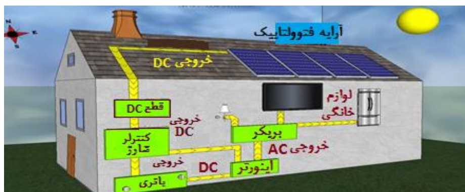
شکل ۱. مراحل نمایش داده شده تبدیل انرژی یک سیستم فتوولتایک خانگی
