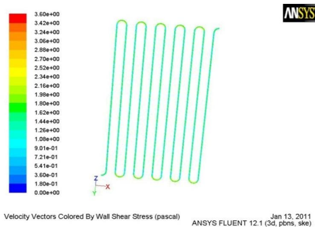
شکل ۱۰: توزیع تنش در بدنه رایزر، Re=3032.35
