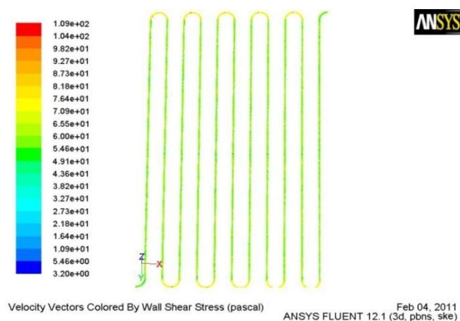
شکل ۱۱: توزیع تنش در بدنه رایزر، Re=30323.5
