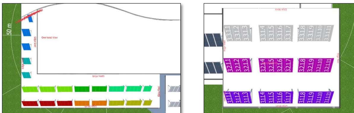
شکل ۷. اتصالات الکتریکی و آرایش استرینگ‌ها به اینورترها
