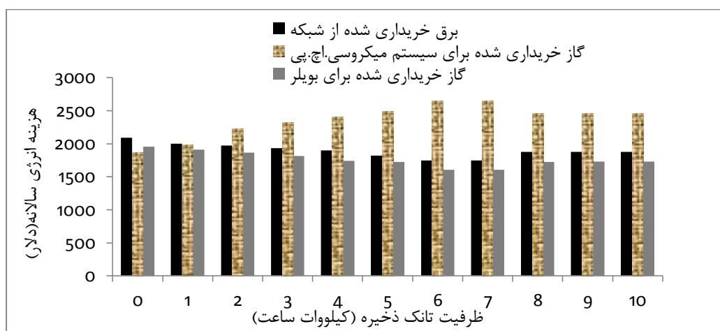
شکل ۱۰: اثر ظرفیت تانک ذخیره بر هزینه انرژی سالانه با استفاده از یک سیستم ۱.۵ کیلوواتی
