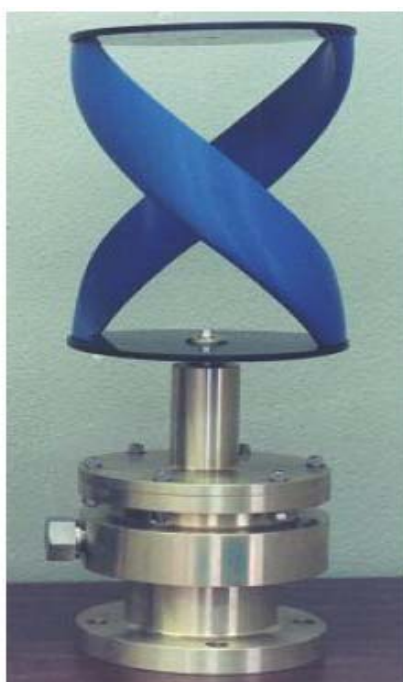
شکل ۱: نمونه ای از توربین Gorlov با دو پره
