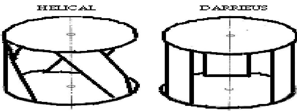
شکل ۴: توربینهای مارپیچی و Darrieus
