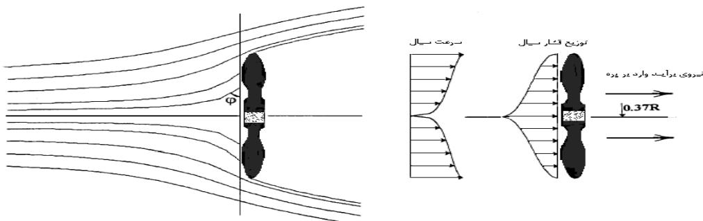
شکل ۳: مدل GGS با راندمان صفر برای  $\varphi = \pi/2$  یا  $\varphi = 3\pi/8$  و راندمان ماکزیمم ۳۰.۱٪ برای  $\varphi = 0$
