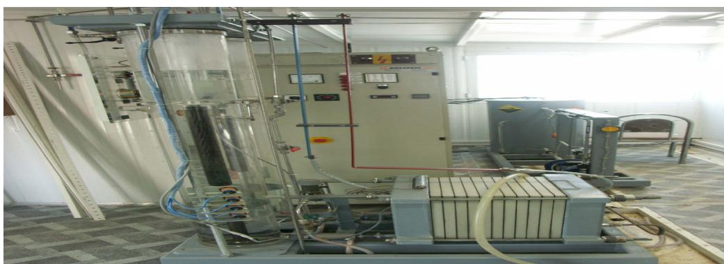
شکل ۵: نمایی از دستگاه الکترولیز آب مدل EV05/10
