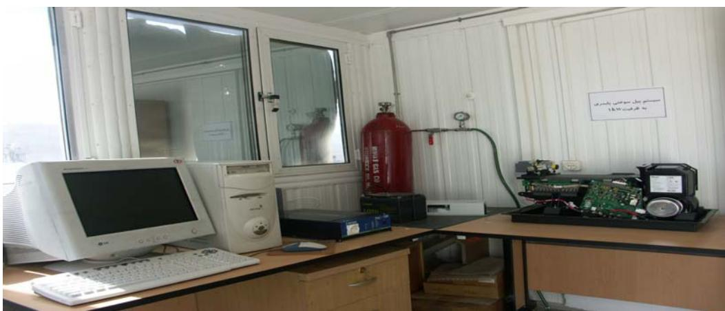
شکل ۶: نمایی از سیستم پیل سوختی پلیمری مدل Nexas1200
