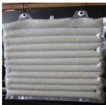
شکل ۵) رول‌های انعطاف پذیر حاوی ماده تغییر فازدهنده و پاتل‌های سخت قابل نصب حاوی ماده تغییر فازدهنده
