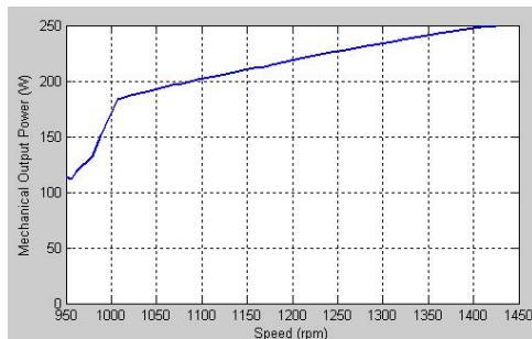
شکل ۱۴: منحنی توان مکانیکی خروجی بر حسب سرعت
