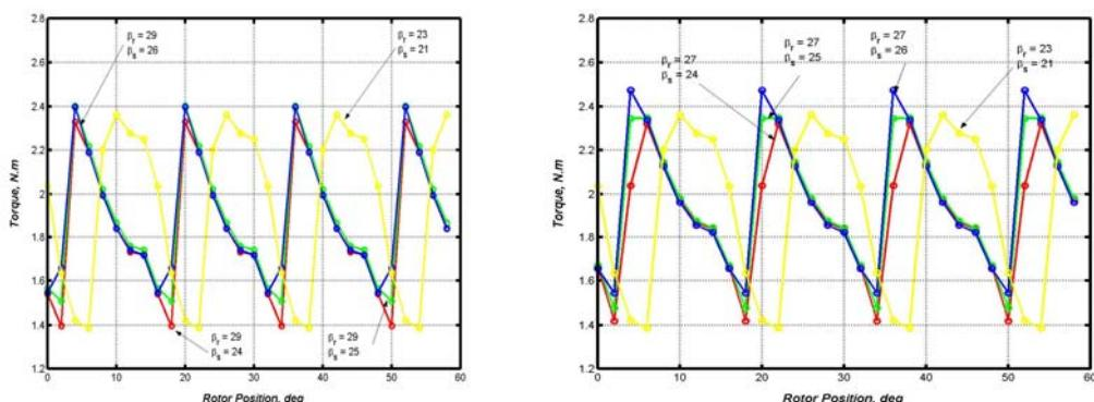
شکل ۵: مقایسه گشتاور چهار فاز با تغییرات زوایای قطب روتور و استاتور
