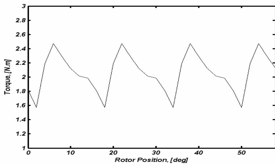
شکل ۹: گشتاور چهار فاز در طرح نهایی موتور
