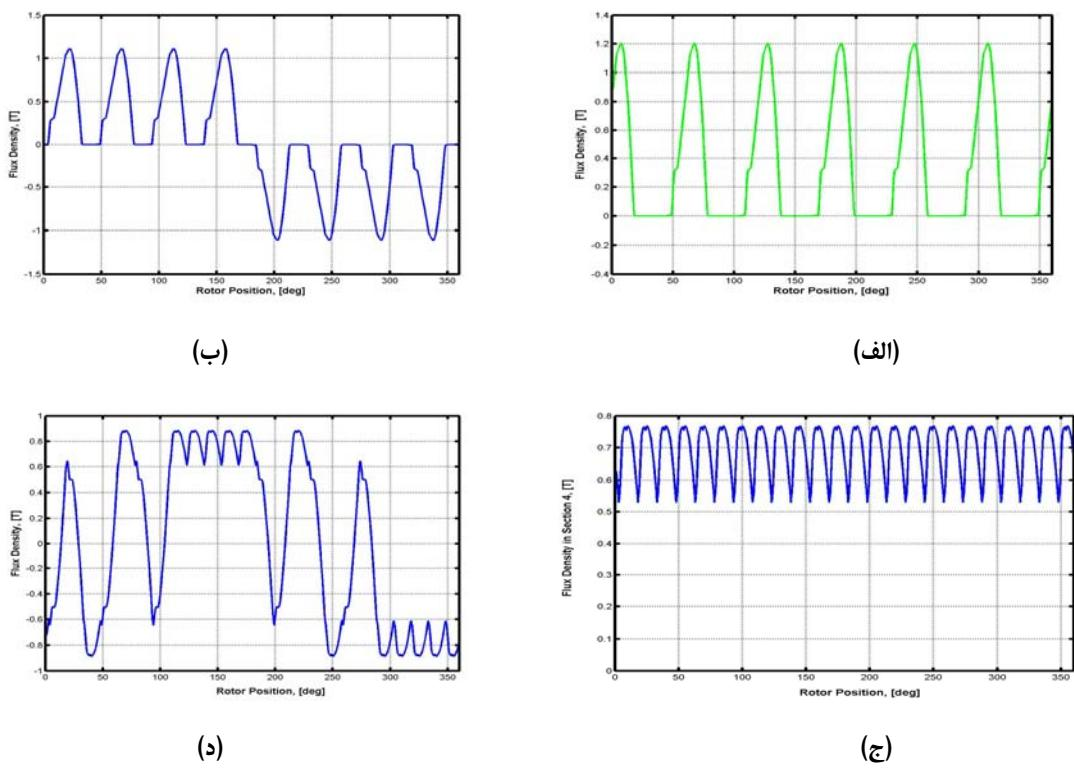
شکل ۴: شکل موج‌های چگالی شار در (الف: قطب‌های استاتور، ب: قطب‌های روتور، ج: یوگ استاتور و د: هسته روتور در یک دور گردش کامل روتور
