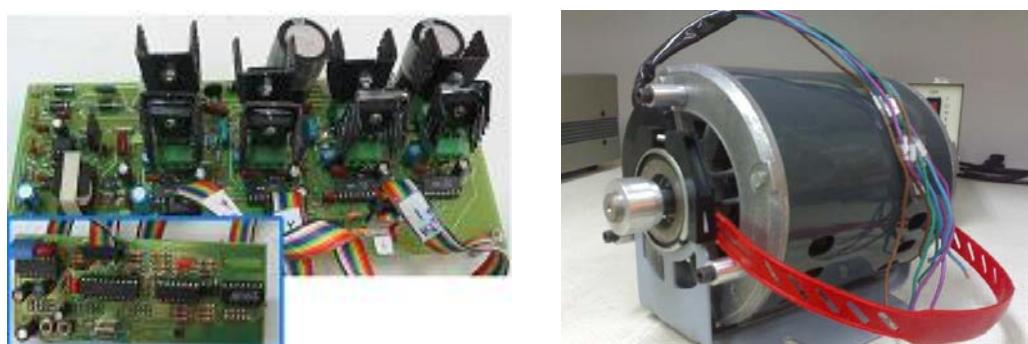
شکل ۱۲: درایور موتور سوئیچ رلوکتانس
