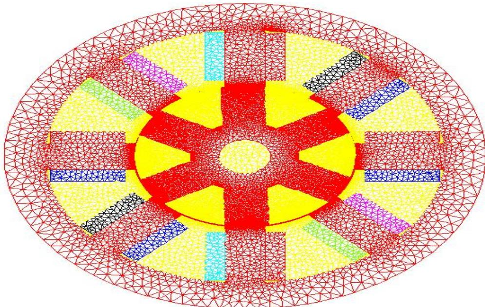
شکل ۲: مدل‌سازی و مشبندی موتور سوئیچ روکتانس ۸/۶
