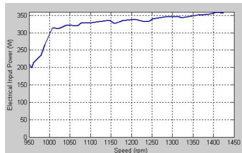
شکل ۱۵: منحنی توان الکتریکی ورودی بر حسب سرعت
