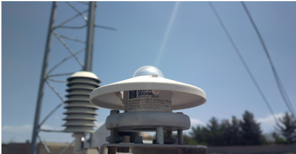
شکل ۳) سنسور اندازه گیری دما و تابش کل موجود در ایستگاه سینوپتیک رفسنجان
