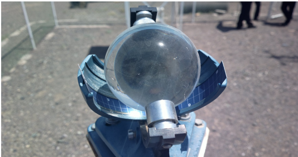
شکل (۷) دستگاه آفتاب نگار موجود در ایستگاه سینوپتیک رفسنجان
