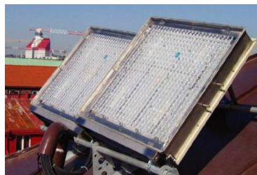
شکل ۸- جمع‌کننده نور خورشید برای سیستم فیبر نوری [۱]
