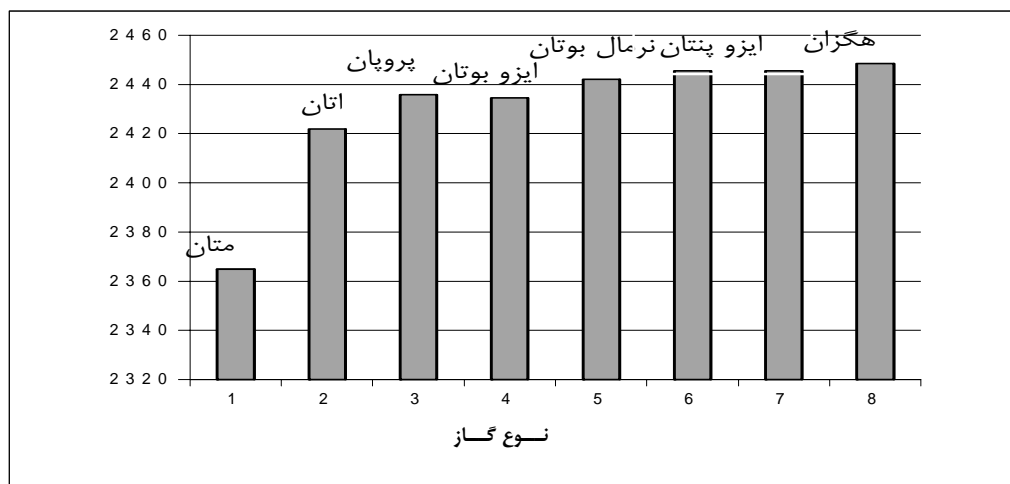
شکل ۱: مقایسه دمای شعله آدیباتیک گازهای تشکیل دهنده گاز طبیعی
