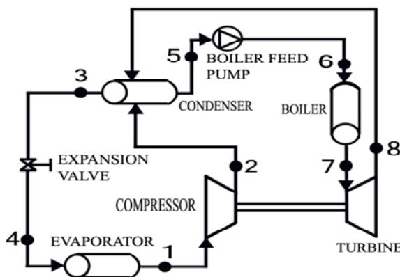
شکل ۱) شماتیک سیستم ترکیبی توان ، تبرید[۶]
