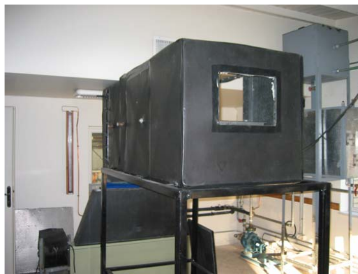
تصویر (۱): یک نمونه فن کویل تحت آزمون به همراه کانال دریافت
