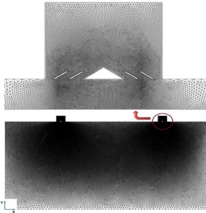
شکل ۶) تصویر شبکه بندی به همراه بزرگنمایی آن
