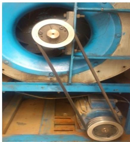
شکل (۴) تصاویر پولی های بلور و الکتروموتور بعد از اصلاح
