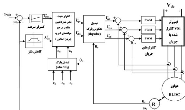
(الف) بلوک دیاگرام روش کنترل برداری بهبودیافته
