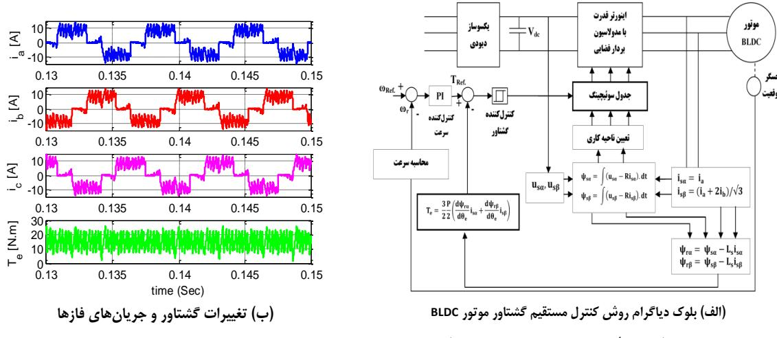
شکل ۶) کنترل موتور BLDC به روش کنترل مستقیم گشتاور از نوع هدایت جریان در دو فاز
