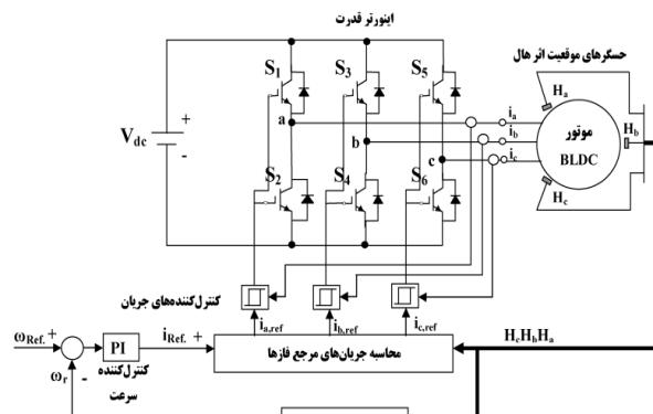
(الف) بلوک دیاگرام روش تنظیم جریان سه فاز
