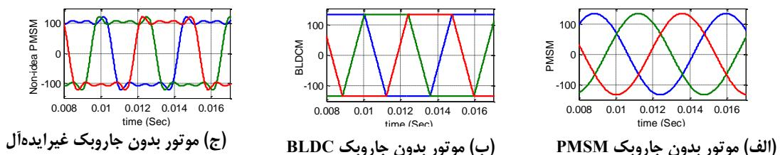
شکل (۱) شکل موج ولتاژ ضدحرکه سه‌فاز در انواع مختلف موتورهای آهنربای دائم بدون جاروبک AC
